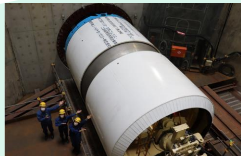
↑下水道工事PR用撮影にて。シールドマシン ※ [検索]詳しくは、上下水道局ウェブサイトで！
